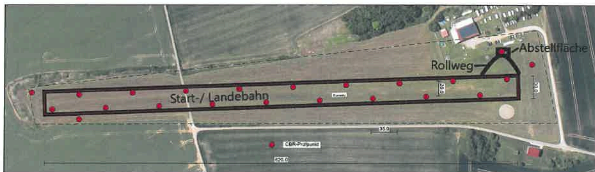
Abbildung 4: Luftbild mit Lage der CBR-Prüfungen im Bereich der Start-/ Landebahn
