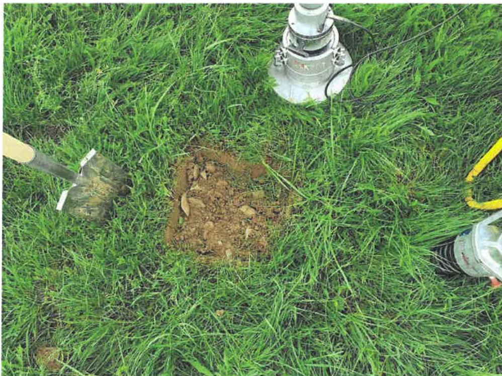
Foto 4: Handschurf Prüfpunkt CBR 18
