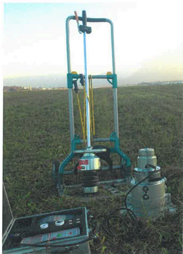
Bild 2: dynamisches CBR-Gerät (links Messgerät, Mitte Belastungsvorrichtung des LFG, rechts CBR-Stempel im Führungstopf)
