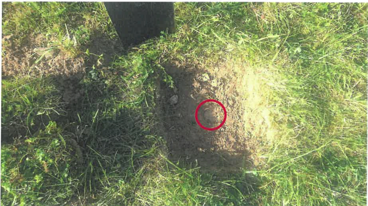
Bild 3: Handschurf ( \approx 30 \times 30 \text{ cm}^2 ) bis \approx 0,15 \text{ m} uGOK mit Stempelabdruck nach Versuchsdurchführung (Durchmesser 50 \text{ mm} )
