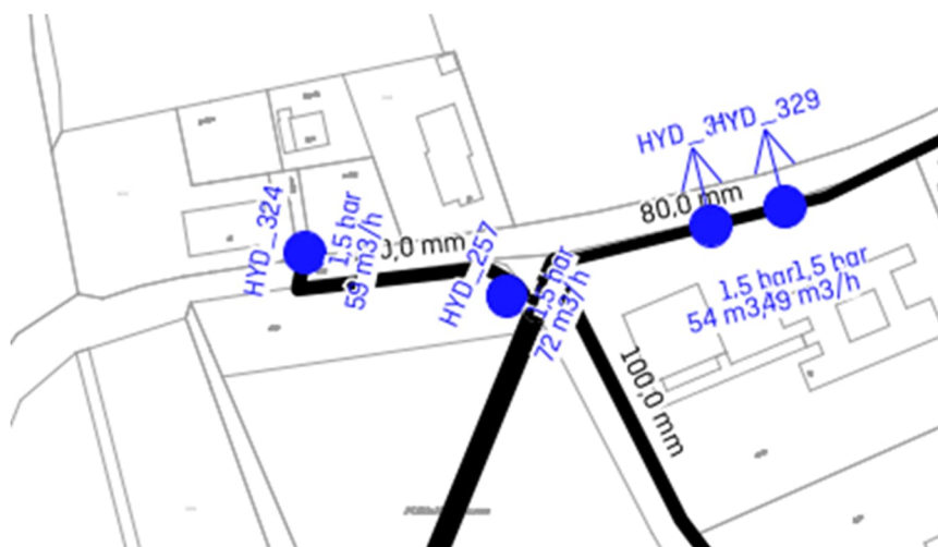
Abb. 2 Auszug aus dem Hydrantenlageplan Seckach – südlicher Teil
